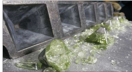
Fig. 4. Zgura este îndepărtată de pe butonul de plumb
