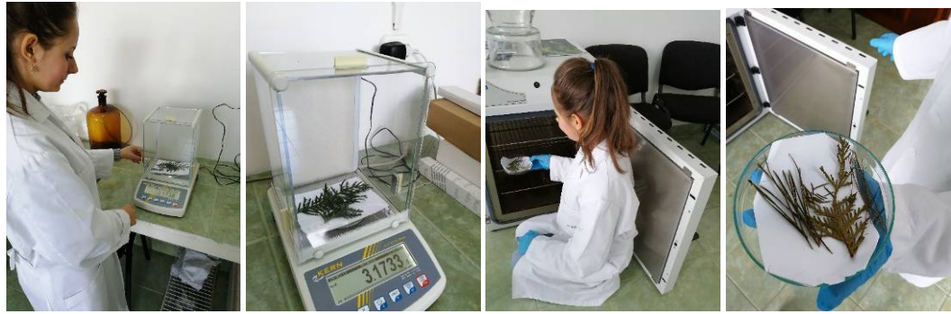
Fig. 4. Determinarea greutății probelor cu balanța analitică și gestionarea probelor din etuvă
