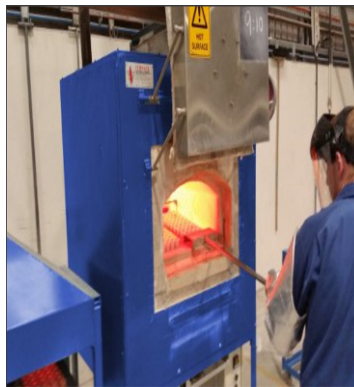
Fig. 6. Cupele sunt introduse în cuptorul de cupelare
