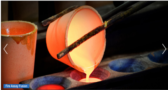
Fig. 3. Descărcarea conținutului în forme de turnare ( https://sabinmetal.com/ , https://alexstewartinternational.com/portfolio-item/21-fire-assay-lead-button/ )
